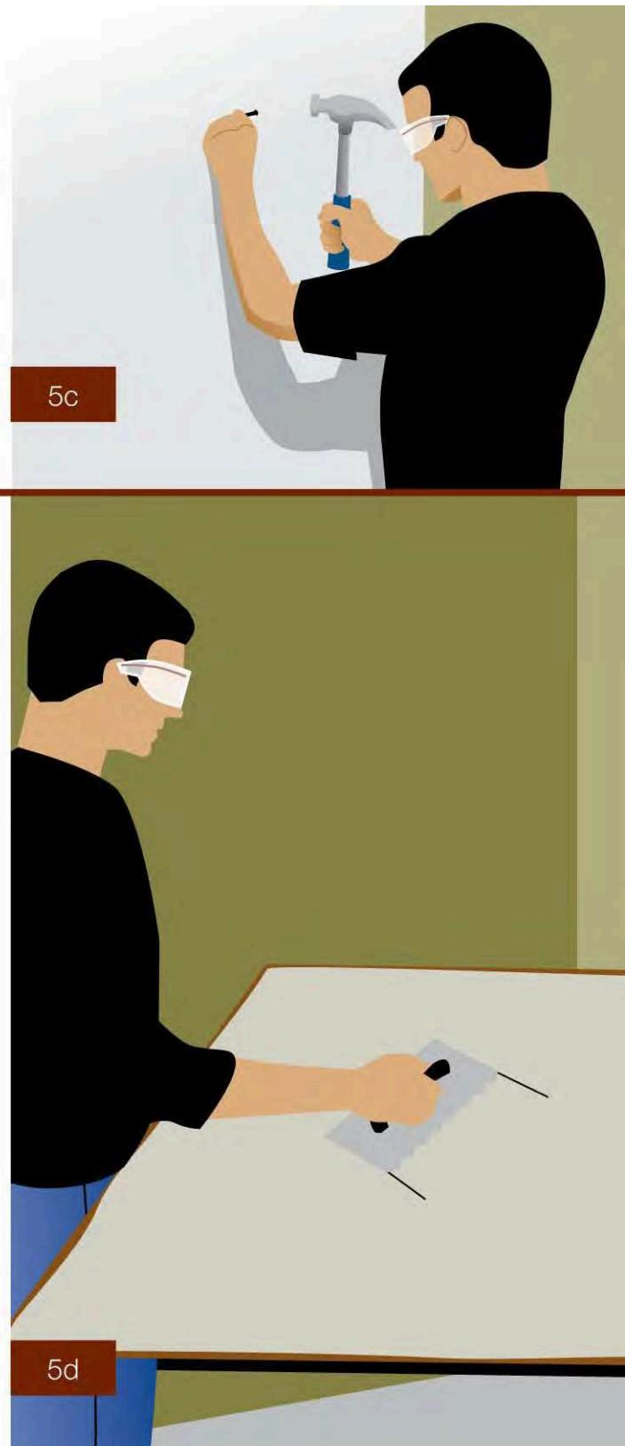
Utilice un adhesivo de alta calidad para construcción o baldosas, a base de solventes, para aplicación con espátula. (No utilice adhesivos de base acuosa o para fibra de vidrio porque no funcionarán). Para aplicar el adhesivo en forma adecuada siga las instrucciones de seguridad y aplicación recomendadas por el fabricante.
