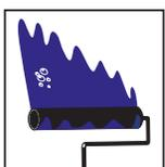
Appliquer le latex sur la surface avec un rouleau ou un pinceau. Dérouler et poser la fibre sur la surface en l'imbibant bien du latex. La fibre doit se chevaucher de 10cm (4") entre chaque lanière pour s'assurer que la surface soit
